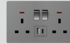
NS6662 13A 2 GANG SWITCHED SOCKET + 1 USB + 1 TYPE C + NEON, DP 13A 250V~50/60Hz, 5V 2.1A فيش 13 أمبير مزدوج + USB
